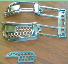
Для сравнения: только что отлитая решетка и готовый результат.
