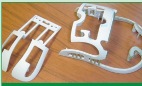
Многие детали после обработки выглядят весьма причудливо, так как с внутренней стороны приходилось оставлять технологические крепления и выступы.
