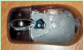
Первый блин вышел комом: мышь отлилась с огромной дыркой в «панцире».
