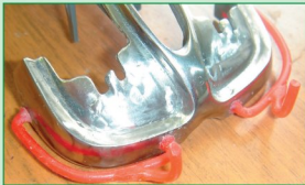
Все детали моделируются из воска, и только потом попадают в печь.
